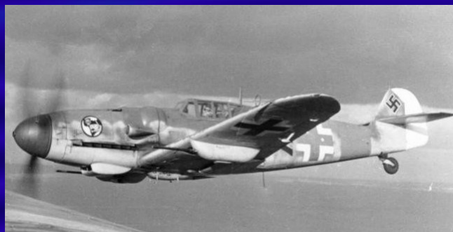
Germania: Messerschmitt Bf 109 Vel. mass. 650 km/h 2 mitragliatrici da 13 mm, e 1 cannone da 20 mm
