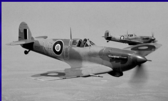
UK: Supermarine Spitfire Vel. mass. 600 km/h 4 mitragliatrici da 7,7 mm e 2 cannoni da 20 mm
