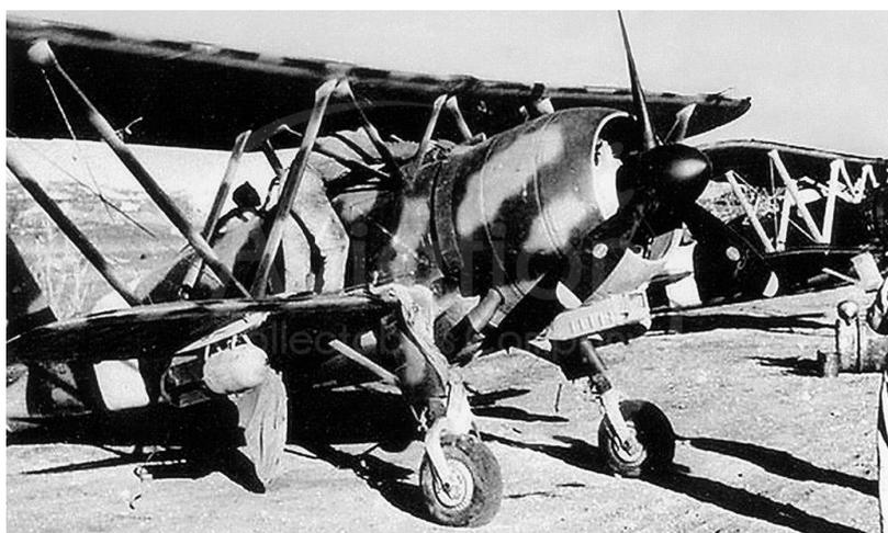
CR 42 AS CB/BA in linea volo in Sicilia, da notare la rimozione delle carenature dei carrelli di atterraggio per agevolare i movimenti a terra in strisce di atterraggio sconnesse.
